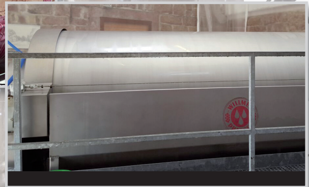
Presse nach der Reinigung mit Ozonwasser vom Univog.
